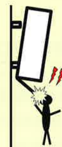
↑ 壁のサビ汁汚れは内部の 取付金具が腐食
